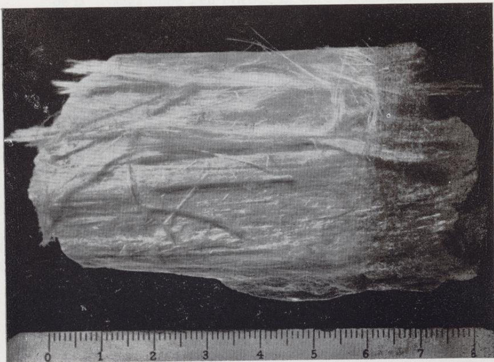
Fot. 8.—Crisotilo "slip fibra" de deficiente calidad, de Ontario (Canadá)
