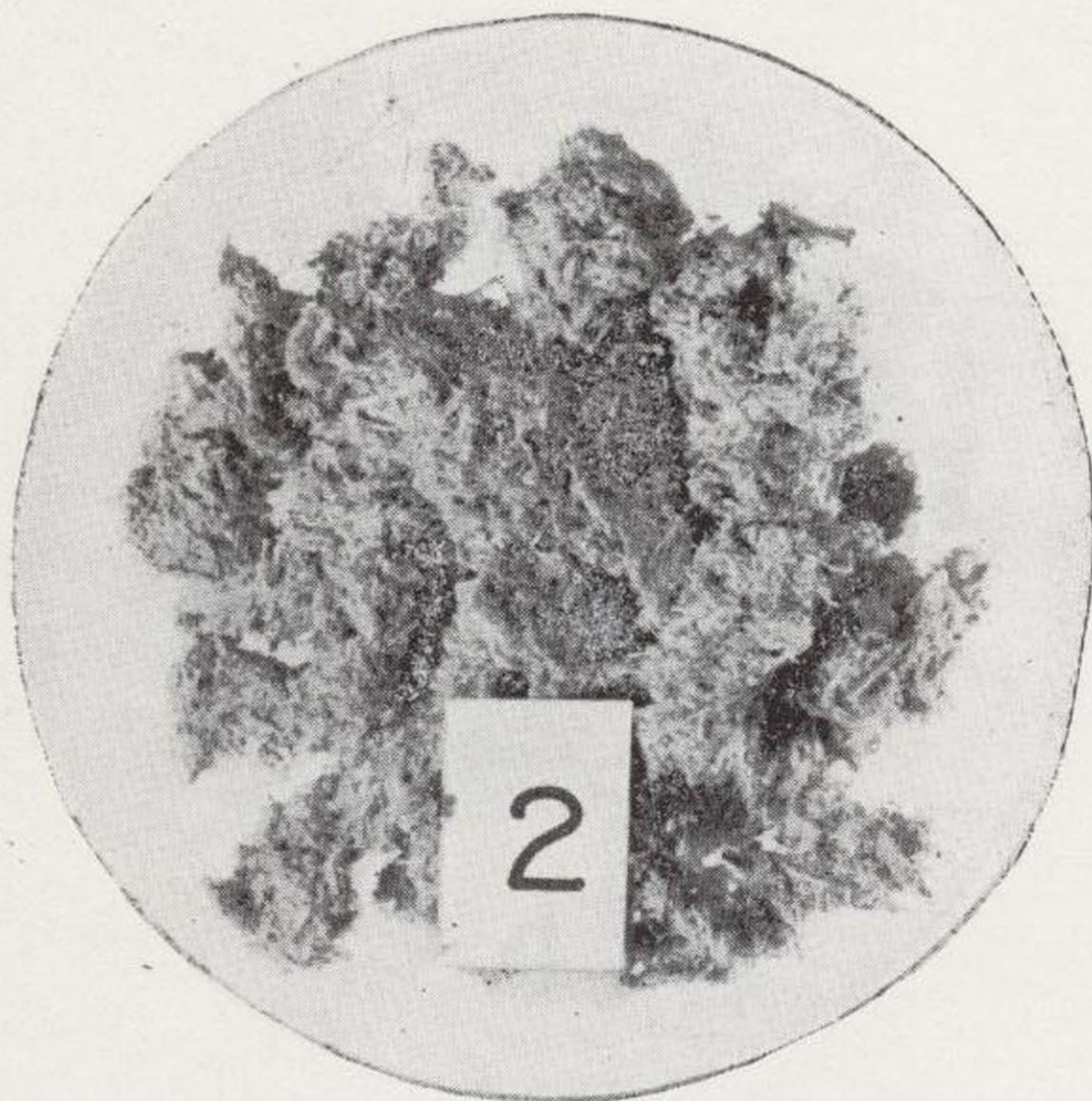
Fot. 22.—Amianto tratado, crisotilo de Swaziland, marca y grado HVL-4.
