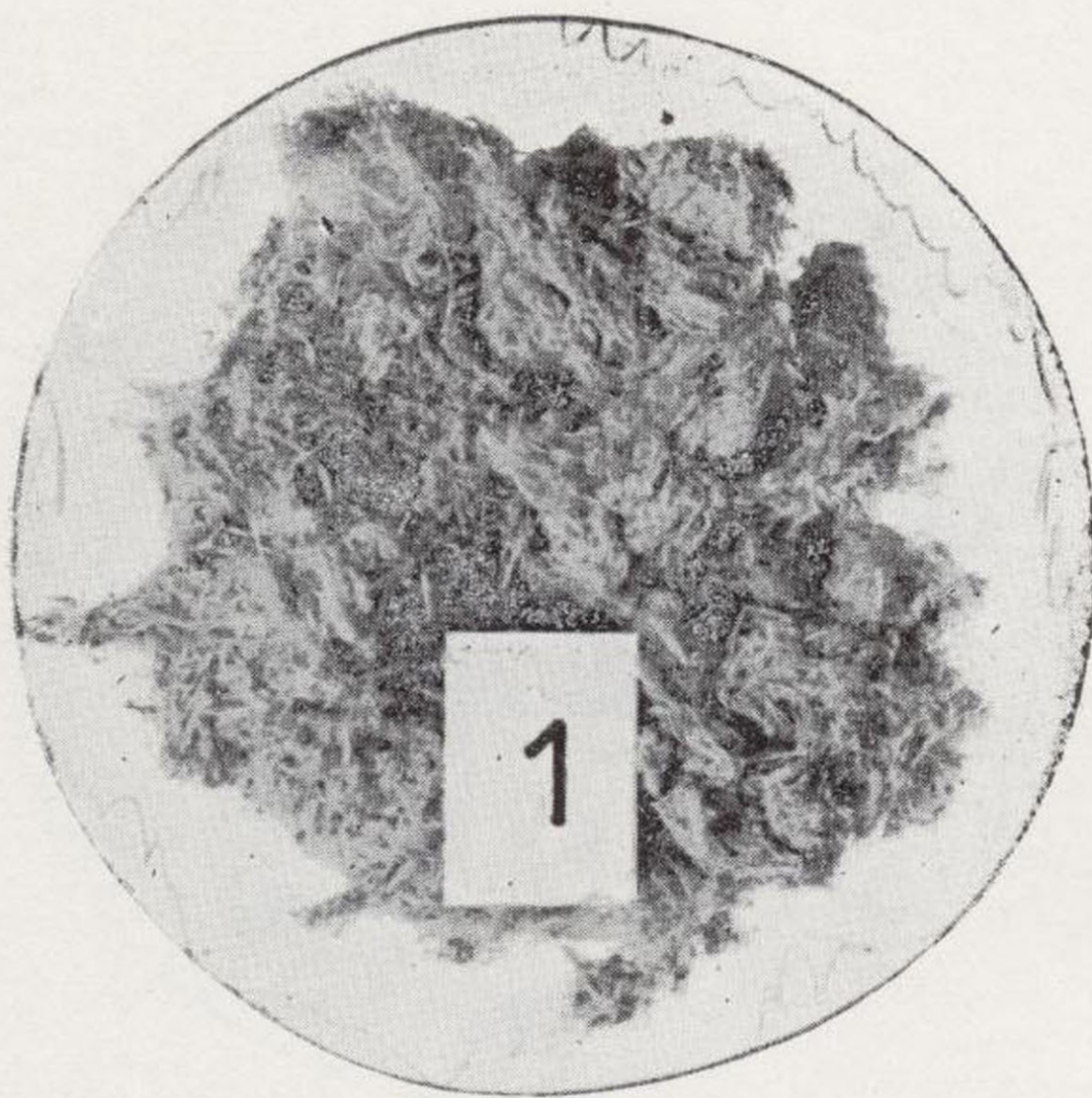
Fot. 21.—Amianto tratado, crisotilo de Swaziland, marca y grado HVL-3. (Tamaño 1,1 del natural.)
