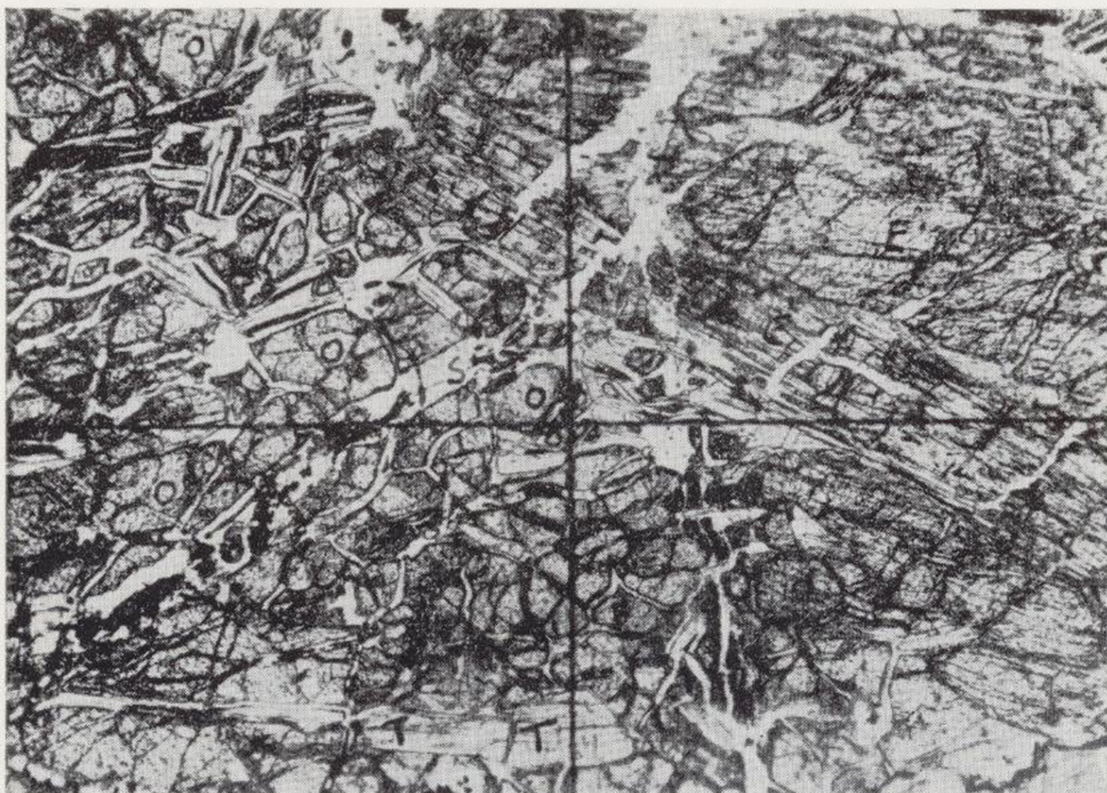
Microfoto 2.—Muestra núm. 2, de la zona de Melliz.—Preparación I. Aspecto general de la harzburgita. Principalmente formada por granos de olivino (O). En el primer cuadrante vemos buenas secciones de enstatita (E) y en el tercero una vetilla de crisotilo (S) con granillos de magnetita (M), y más abajo un cristal de tremolita (T). N. II. × 50.
